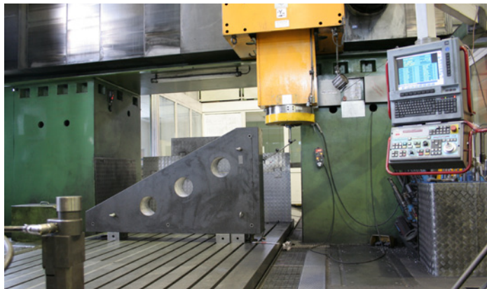
Geometriemessung mit Hartgesteinwinkel.
