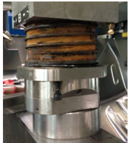
Motor - Spindeltausch an einer HSC Maschine.
